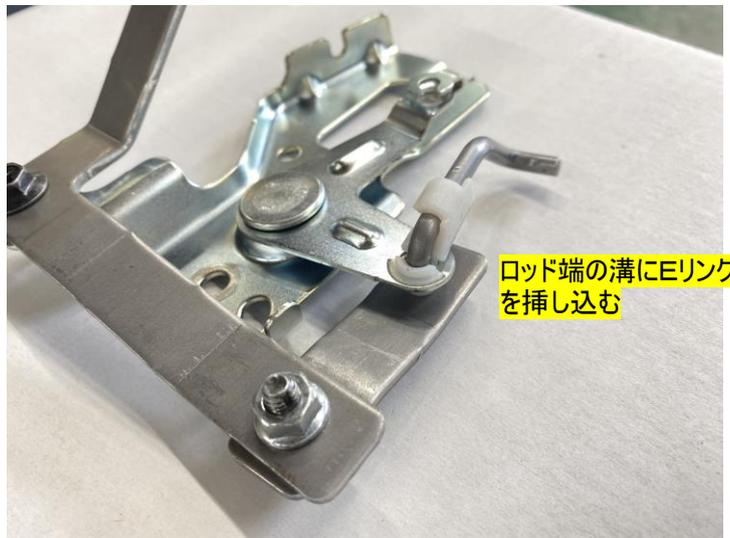
ロッド端の溝にエリング
