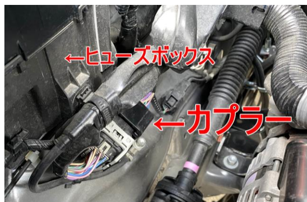
6. AT車は写真のカプラーを固定しているステーを外す。
