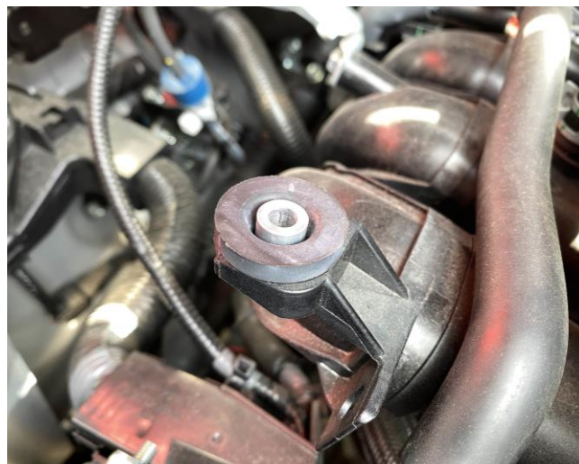
8. エアクリーナーBOXが刺さっていたゴムに付属の15mmカラーを挿す。
