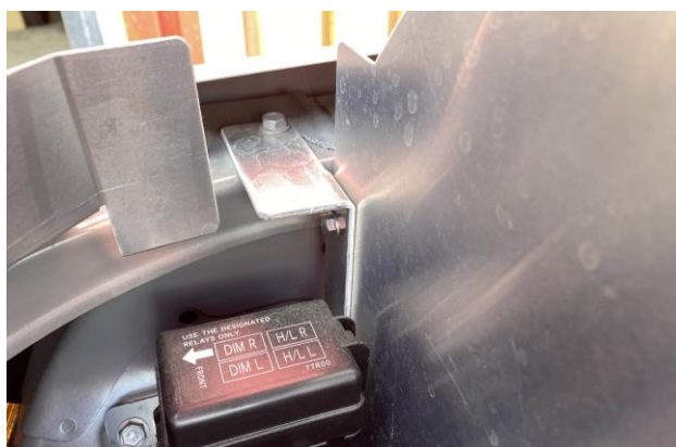
5. ステー中の固定位置。ステーにかぶるコーキングは剥がす。
